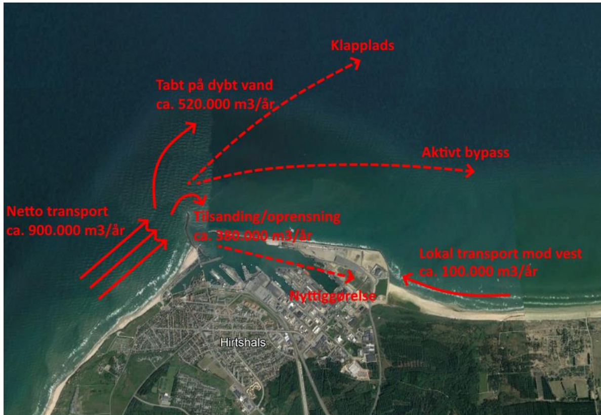
Figur 4-6: Sedimentbudget ved Hirtshals Havn baseret på tidligere foreliggende analyser. Stiplede linjer angiver fordelingen af de 380.000 m 3 /år der oprenses. Baggrundsfoto er fra (Google Earth, 2022)
