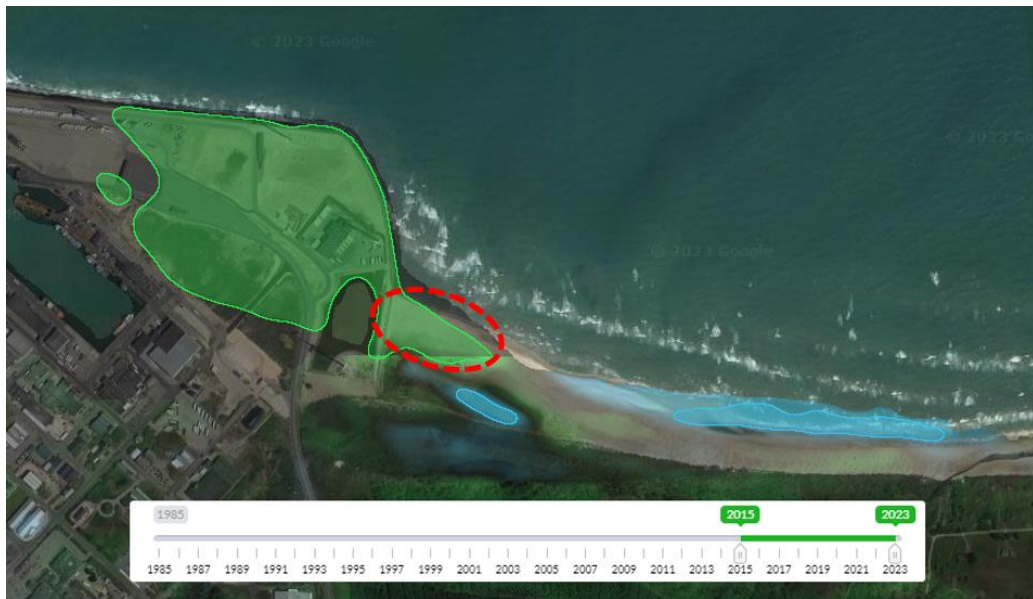
Figur 5-10: Illustration af kystfremrykning (grønne områder) og kysterosion (blå områder) umiddelbart øst for Hirtshals Havn. Den røde skravering illustrerer sedimentationen på kysten umiddelbart øst for havnen. (TUDelft, 2023a)
