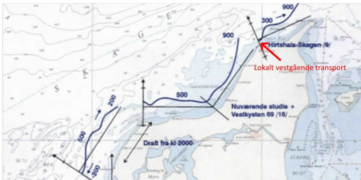
Figur 4-1: Regionalt sedimentbudget i (DHI, 1994) baseret på profilopmåling ud til 10 m vanddybde. Positivt fortegn indikerer netto-nordøstgående transport. Tal er i 1.000 m 3 /år. (DHI, 2000b)
