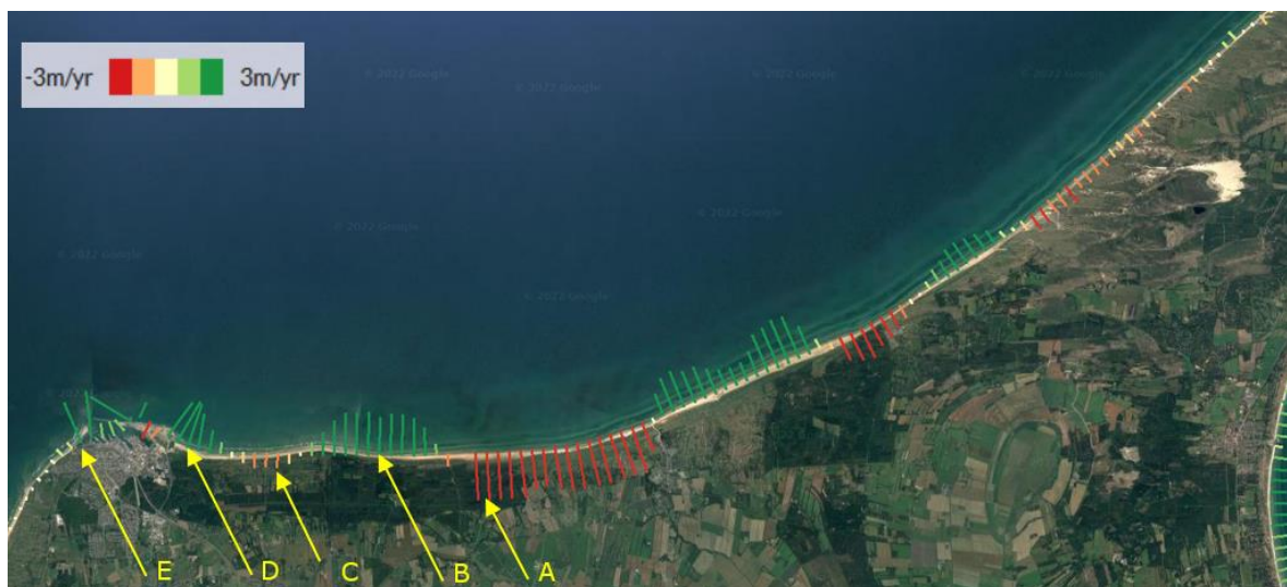
Figur 5-5: Kystudvikling ved Hirtshals Havn i perioden 1984-2016. Røde linjer markerer tilbagerykning og de grønne linjer markerer fremrykning. Pkt. A -E angiver evaluerede lokaliteter ift. fremrykning/tilbagerykning i perioden 1984 – 2016 via (TUDelft, 2023a).
